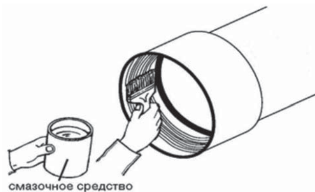
Рисунок Б.3 – Нанесение смазочного средства
