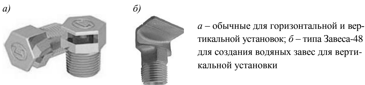
Рисунок 7.5 – Противопожарные дренчерные оросители
